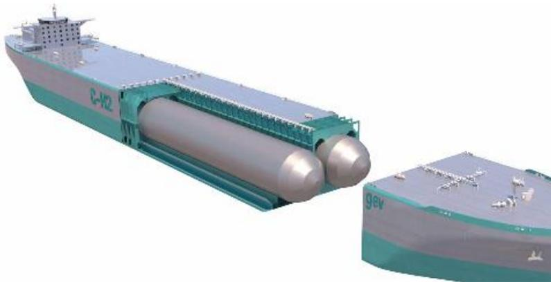
**Abbildung 8: Transportschiff für komprimierten Wasserstoff mit Wasserstoff-Brennstoffzellen-Antrieb<sup>124</sup>**
