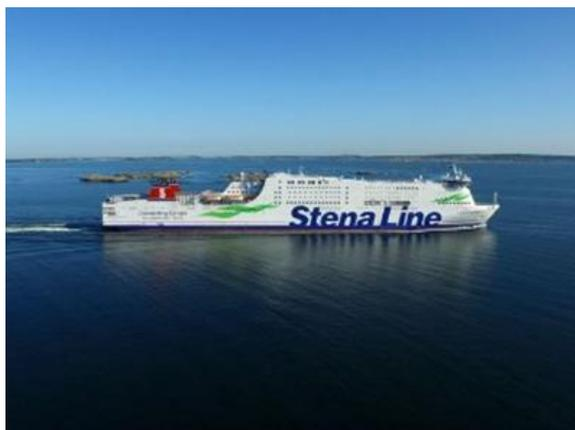
Abbildung 14: Mit Methanol betriebene Fähre<sup>223</sup>
