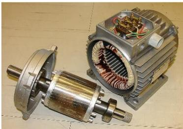
**Abbildung 12: Stator und Rotor eines Elektromotors<sup>171</sup>**
